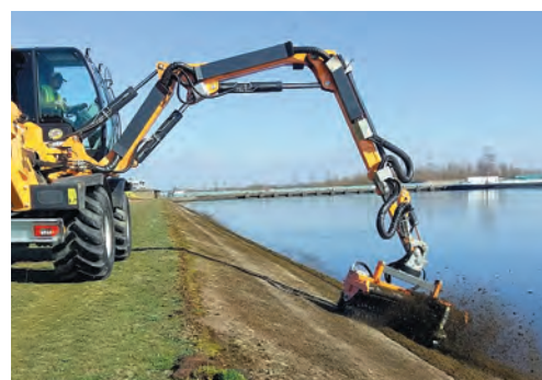
bema 25 mit Wildkrautbürste, Anbau Bagger (Sonderbau)
