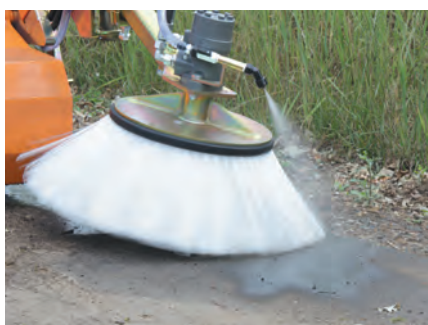
Seitenkehrbesen mit Wassersprüheinrichtung
